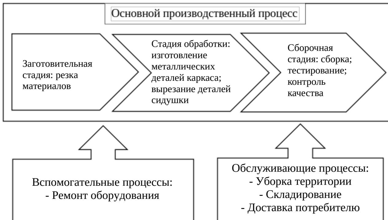
Рисунок 1 Блок-схема производственного процесса
