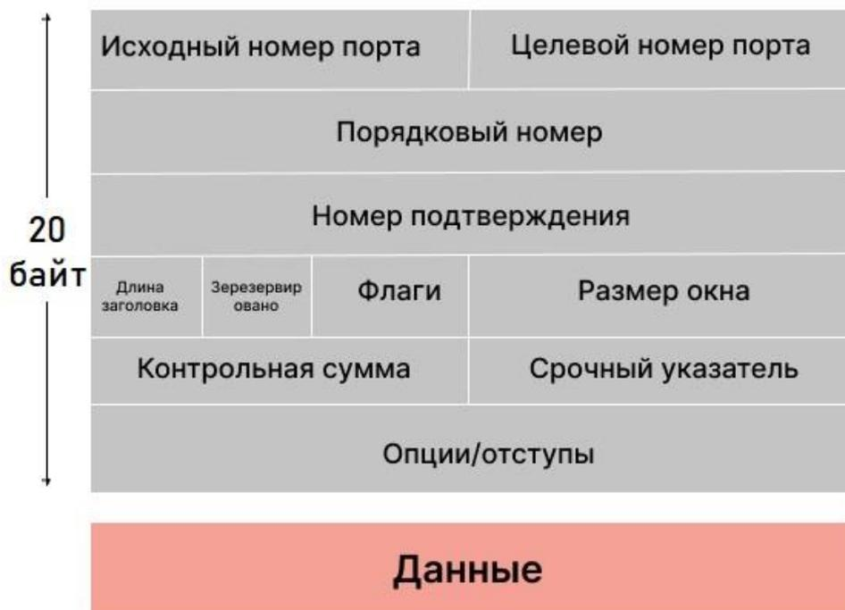
Рисунок 3 – Структура пакета протокола TCP
