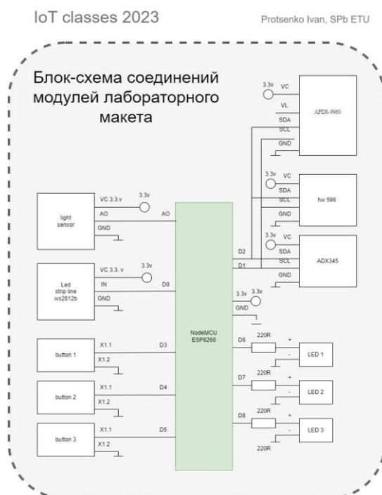
Рисунок 3. Схема подключений макета
