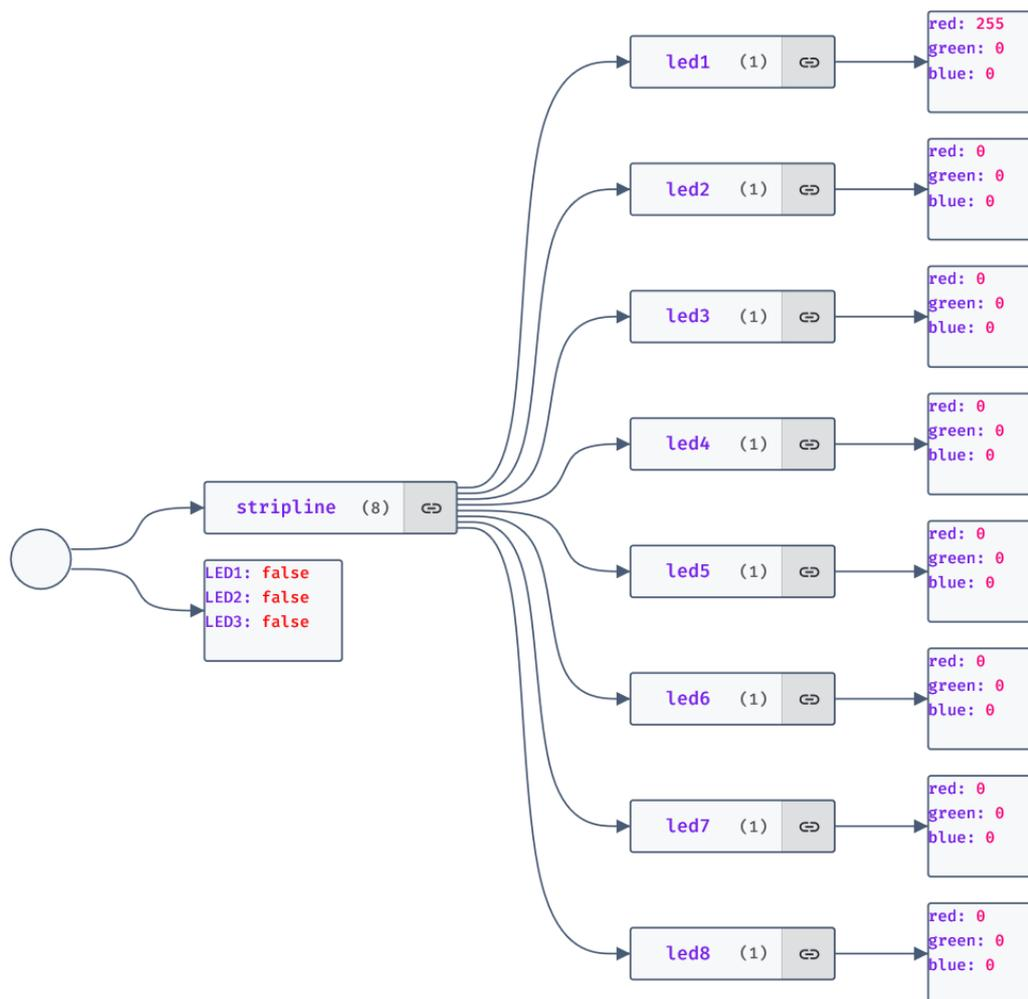
Рисунок 6. Структура JSON для POST /sensors/leds запроса
