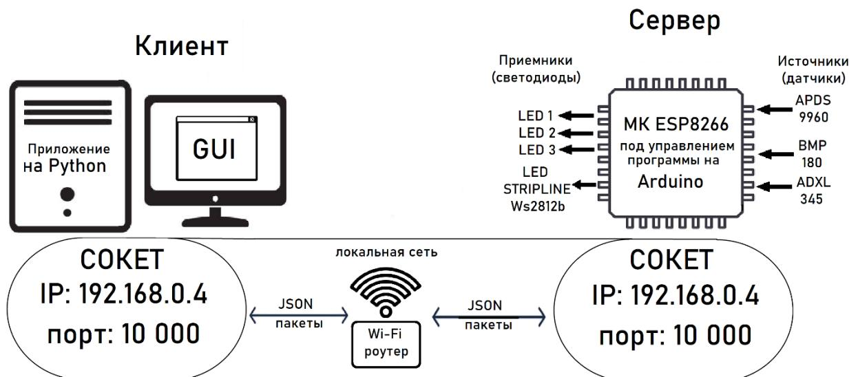
Рисунок 24 – Схема сетевого взаимодействия ПК и МК
