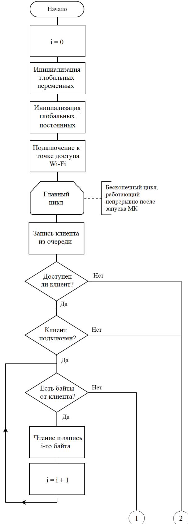
Рисунок Б.1 – Алгоритм программы управления МК
