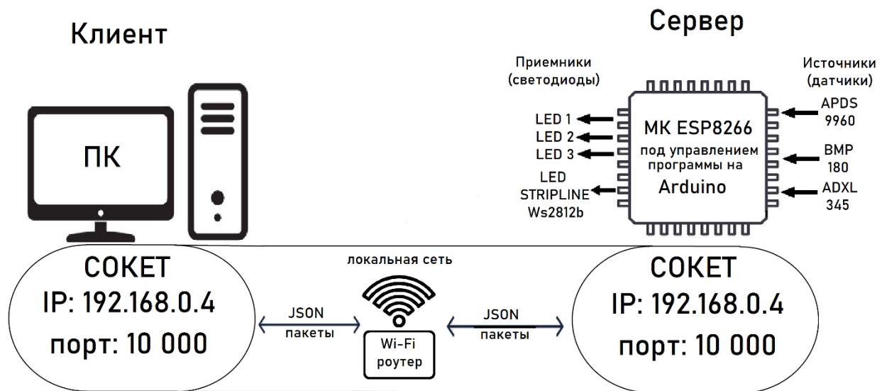
Рисунок 10 – Схема взаимодействия МК и ПК
