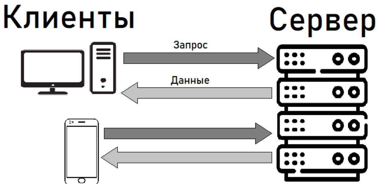
Рисунок 1 – Классическая двухуровневая архитектура клиент-сервер
