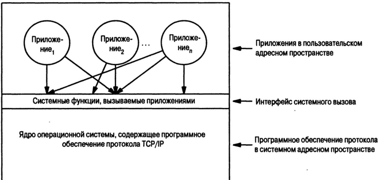
Рисунок 4 – Взаимодействие приложений с ПО протоколов TCP/IP через интерфейс системного вызова
