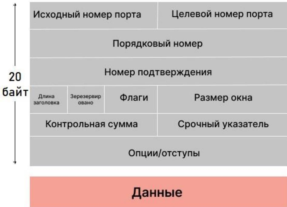
Рисунок 3 – Структура пакета протокола TCP
