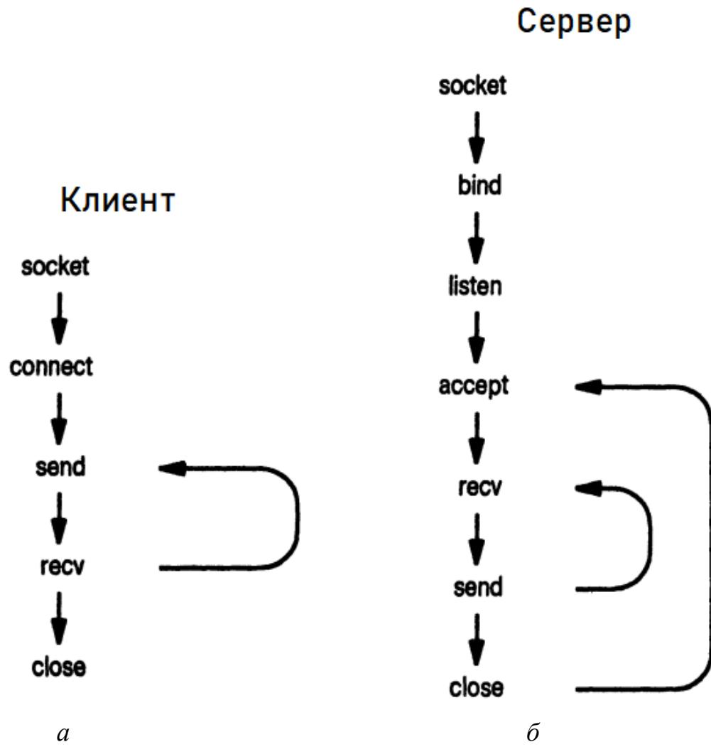
Рисунок 6 – Пример последовательности системных вызовов сокетов для клиента (а) и для сервера (б)
