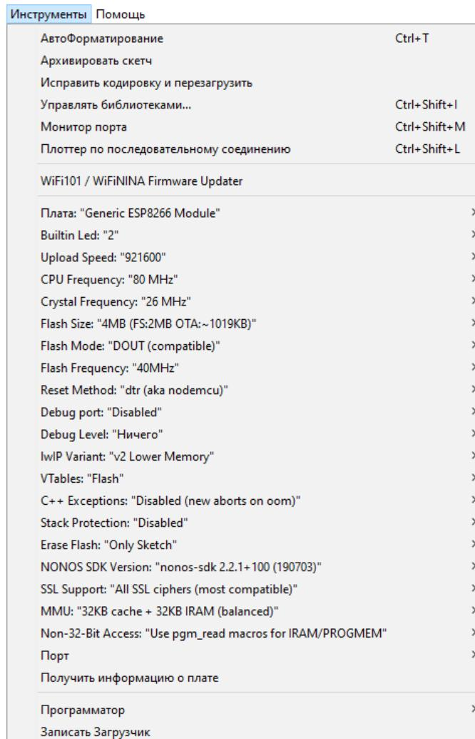
Рисунок 34 – Настройки подключенной платы в Arduino IDE
