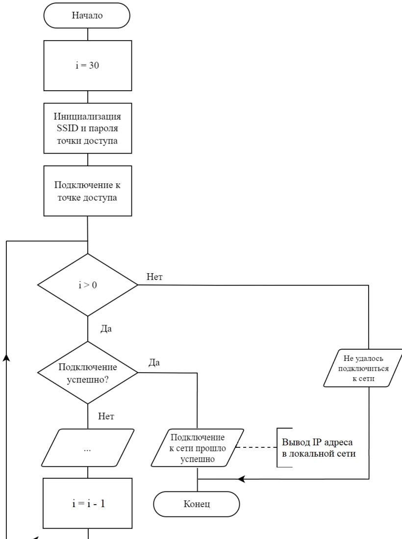
Рисунок 13 – Алгоритм первоначального подключения МК к точке доступа
