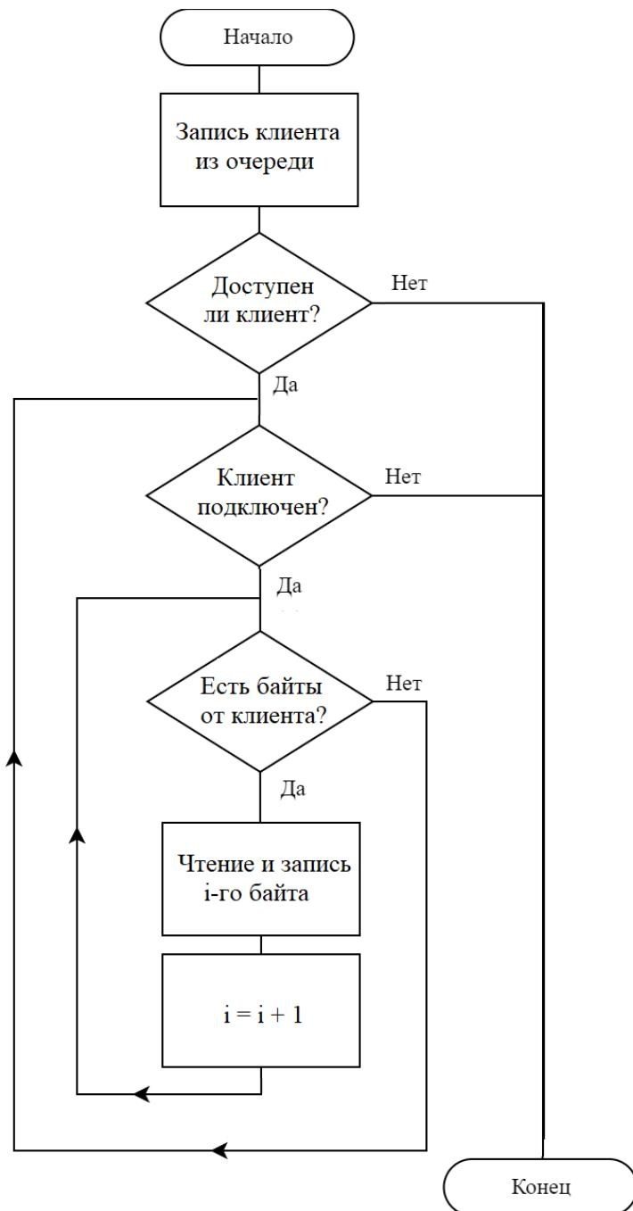
Рисунок 17 – Алгоритм приема данных с ПК
