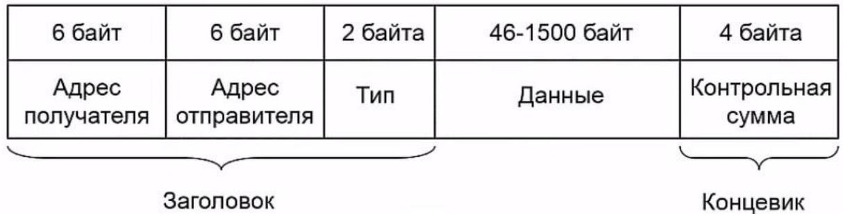
Рисунок 21. Формат кадра классического протокола Ethernet
