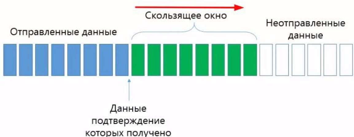
Рисунок 28. Пример подтверждения методом скользящего окна в протоколе TCP
