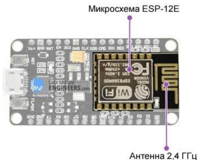
Рисунок 1. ESP-12E и встроенная антенна
