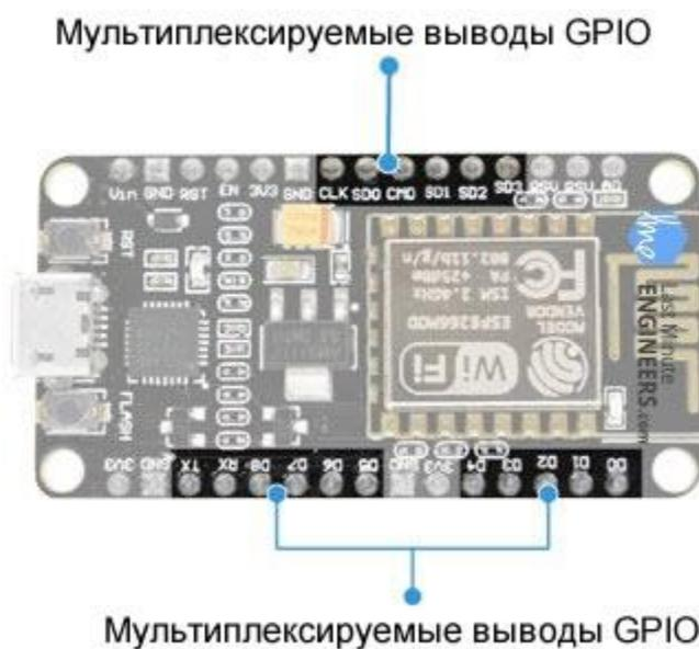
Рисунок 3. Мультиплексируемые выводы GPIO платы ESP8266 NodeMCU
