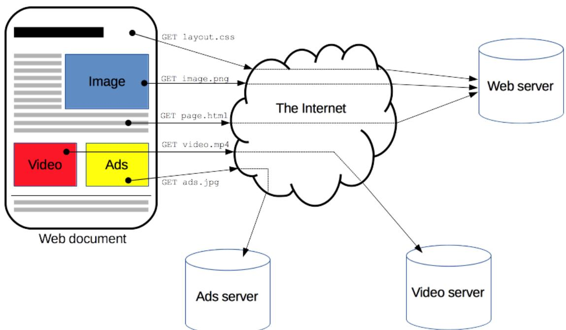
Рисунок 30. Структура протокола HTTP
