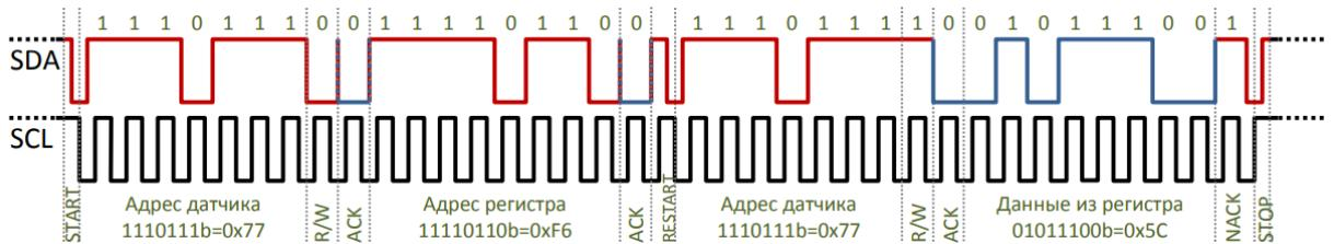
Рисунок 14. Пример чтения байта из регистра 0xF6 (датчик ответил значением 0x5C)
