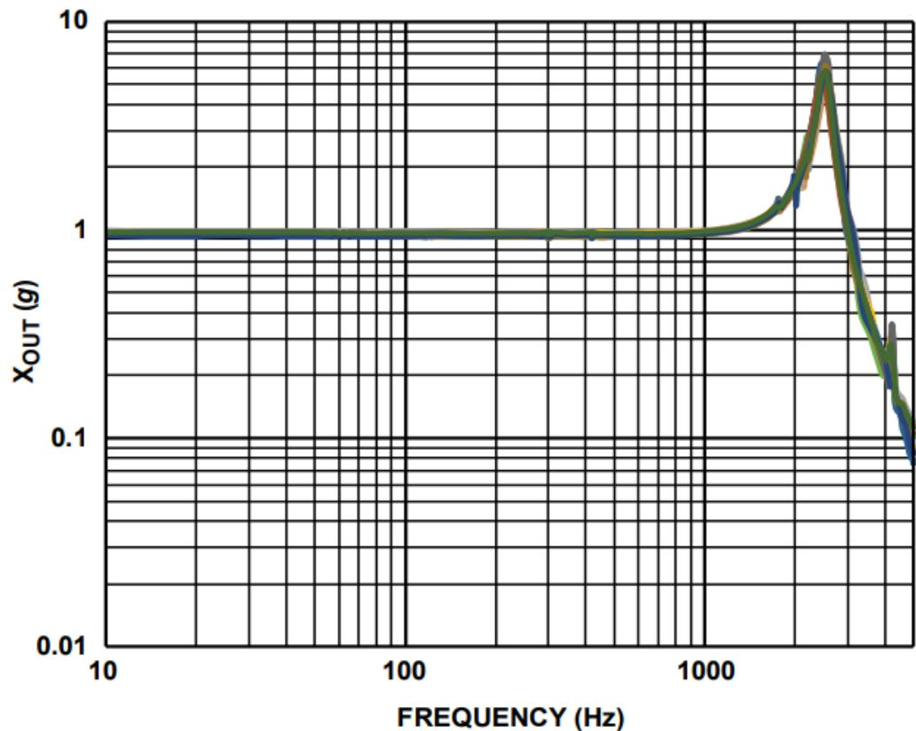
Рисунок 17. Пример реакции акселерометра ADX-354 на движение вдоль оси X
