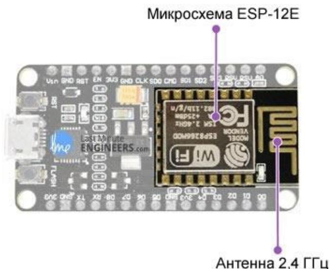
Рисунок 1. ESP-12E и встроенная антенна
