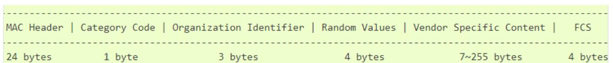
Рисунок 32. Формат пакета в протоколе ESP-NOW
