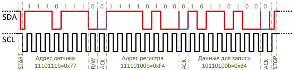
Рисунок 13. Пример записи в регистр 0xF4 значения 0xB4
