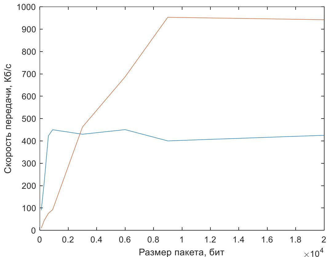
Рисунок 44. Зависимость скорости передачи данных от размера пакета при использовании протокола HTTP (синий) и MQTT (оранжевый)
