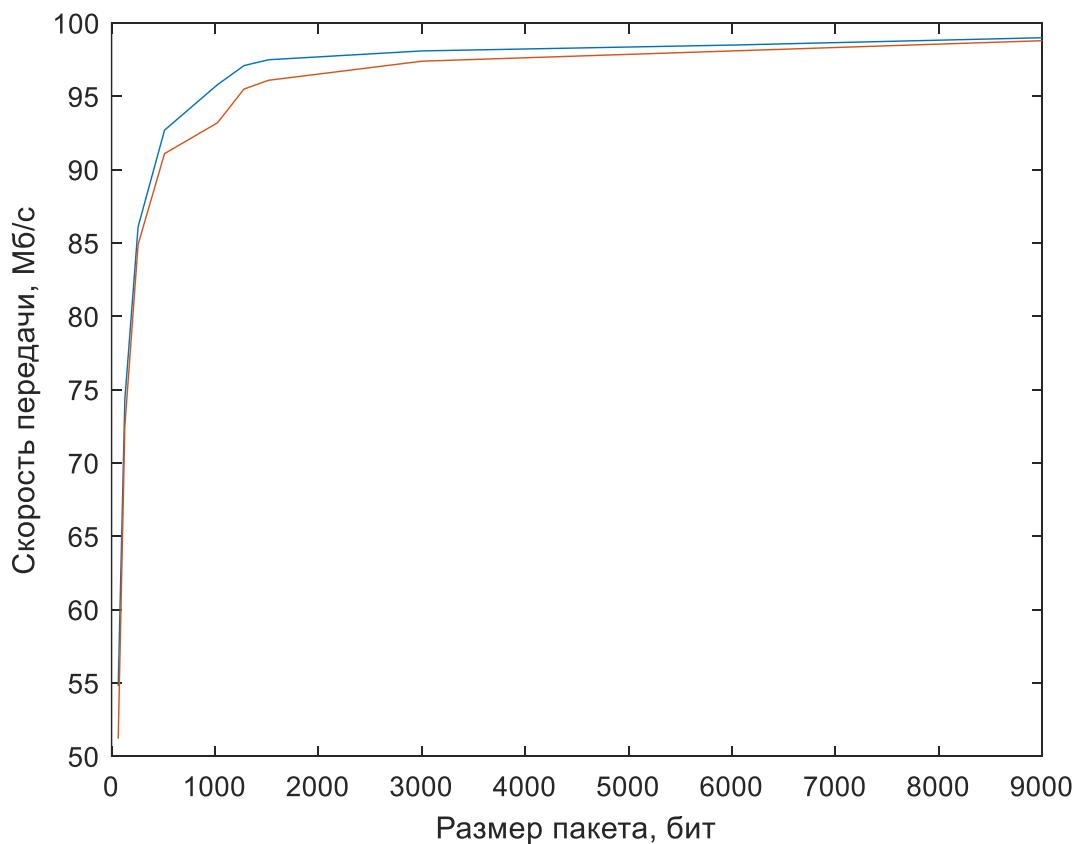
Рисунок 37. Производительность сети с применением протокола TCP/IPv4 (синий) и TCP/IPv6 (оранжевый)
