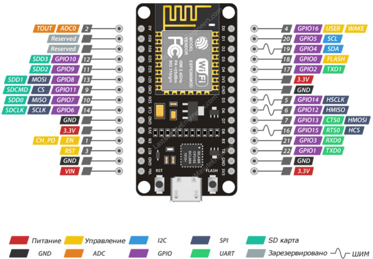
Рисунок 6. Распиновка ESP8266 NodeMCU
