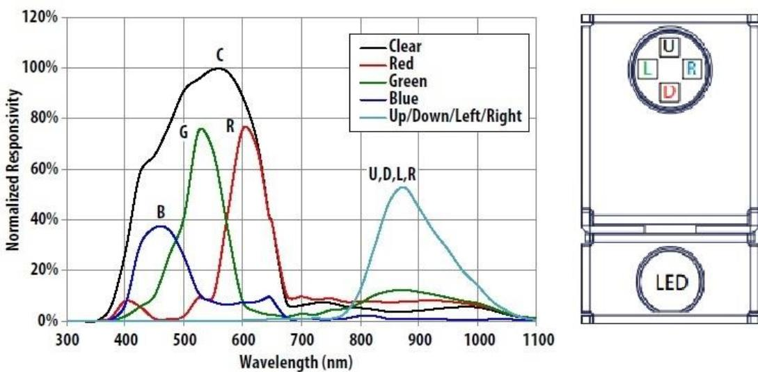
Рисунок 8. Действие сенсора в спектральной области
