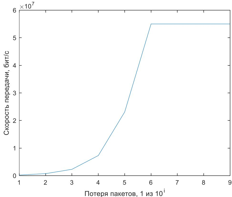
Рисунок 39. Зависимость скорости передачи от количества потерянных пакетов.
