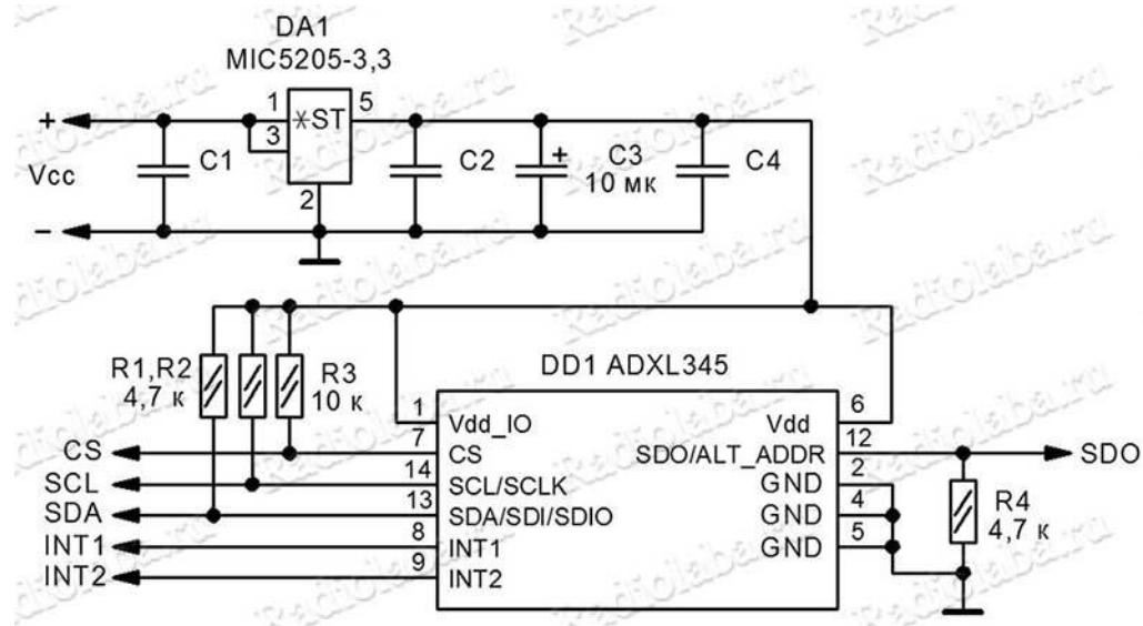
Рисунок 16. Принципиальная схема акселерометра ADX-354
