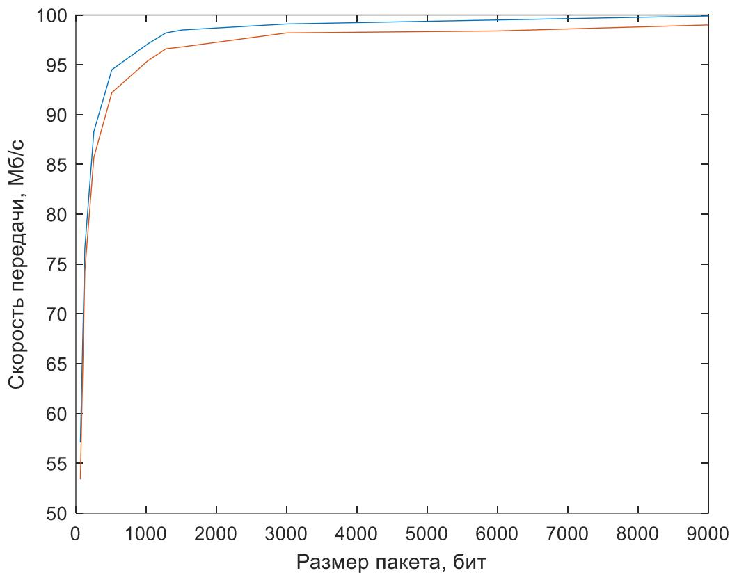
Рисунок 38. Производительность сети с применением протокола UDP/IPv4 (синий) и UDP/IPv6 (оранжевый)
