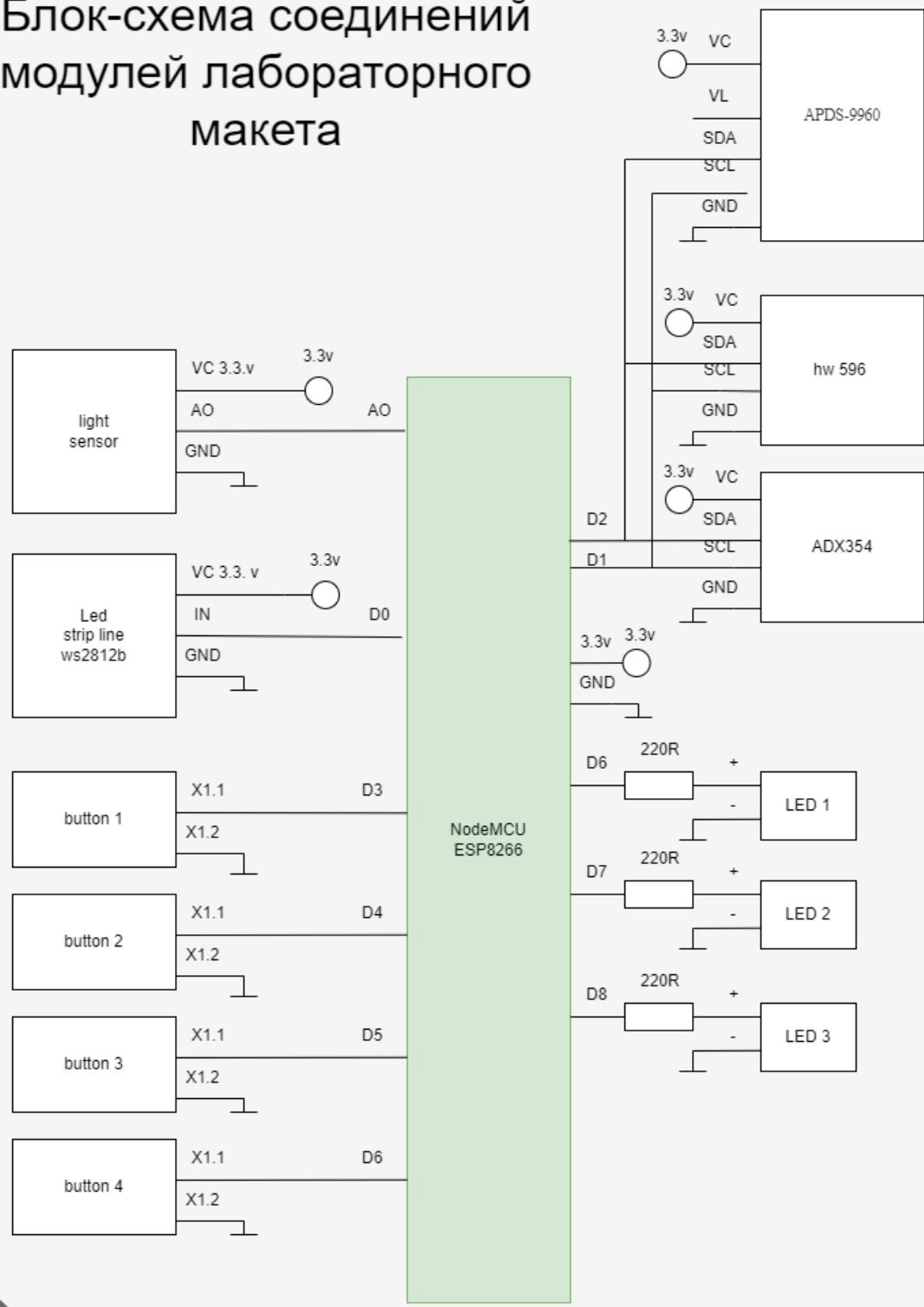
Рисунок 35. Блок-схема лабораторного макета
