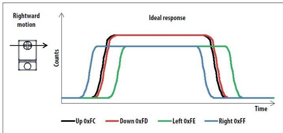
Рисунок 9. Реакция сенсора на направление сигнала
