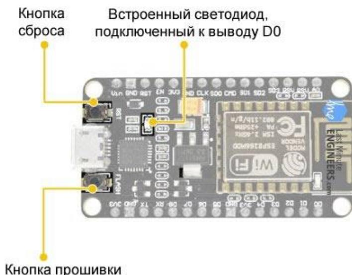
Рисунок 4. Кнопки и светодиоды на плате ESP8266 NodeMCU
