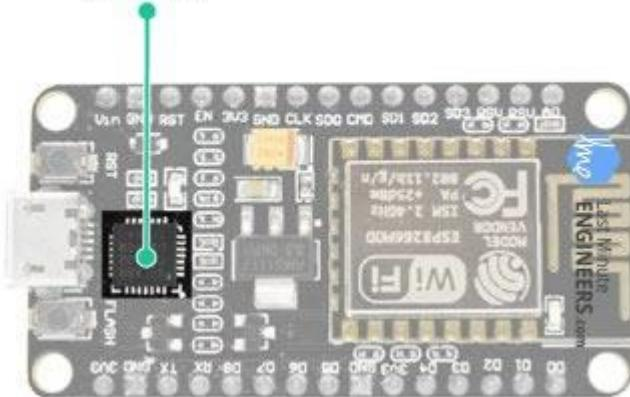
Рисунок 5. Преобразователь USB↔TTL CP2102
