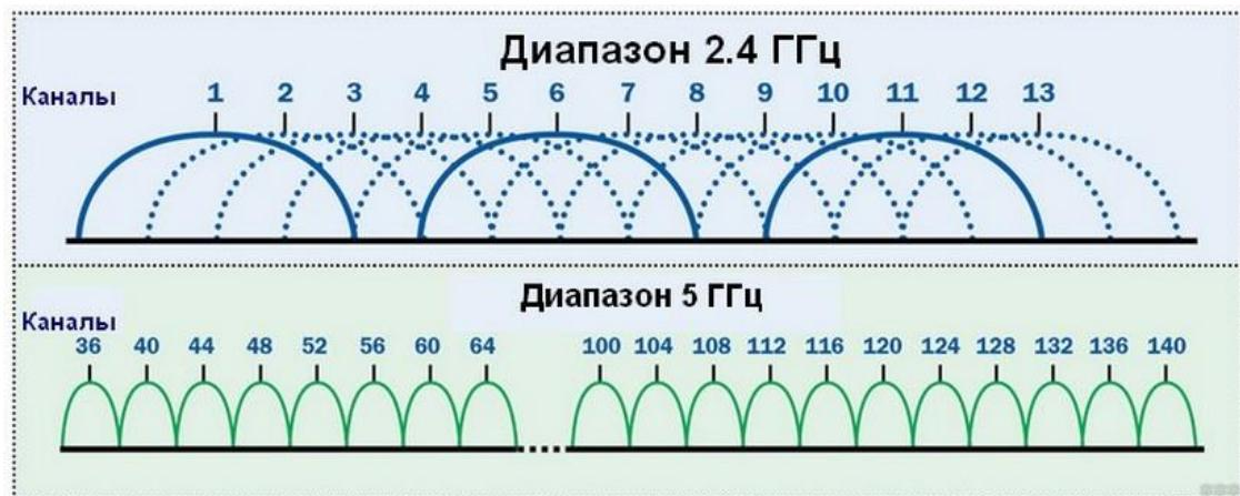
Рисунок 18. Частотный диапазон Wi-Fi
