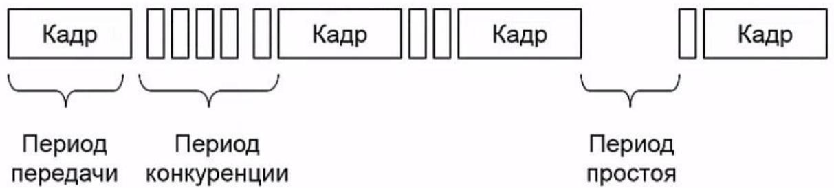
Рисунок 22. Формат кадра классического протокола Ethernet с учетом коллизии
