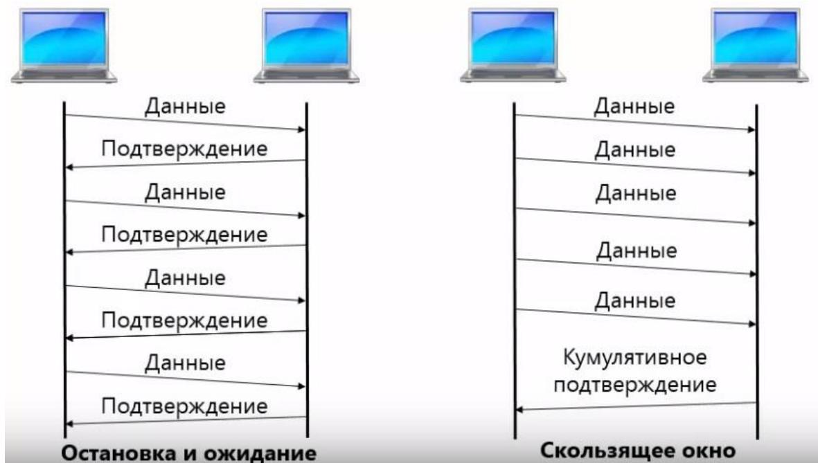
Рисунок 27. Варианты подтверждения доставки в протоколе TCP.
