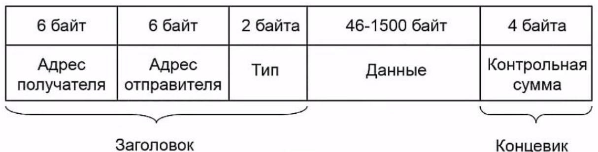
Рисунок 21. Формат кадра классического протокола Ethernet
