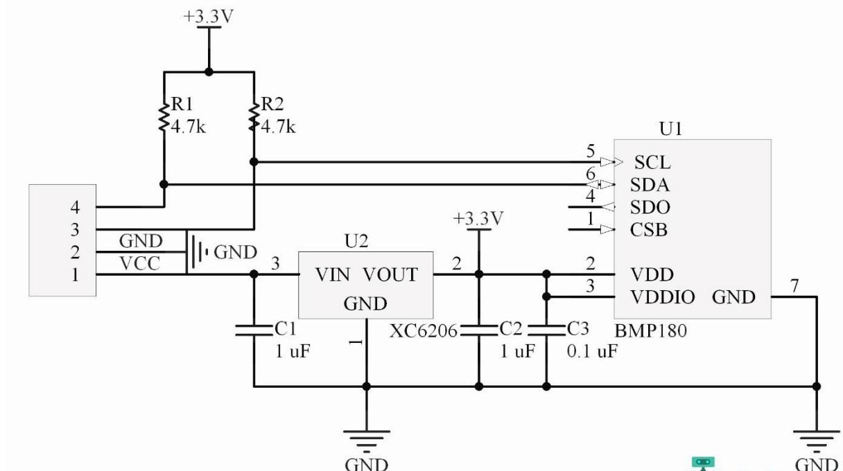
Рисунок 12. Принципиальная схема BMP-180
