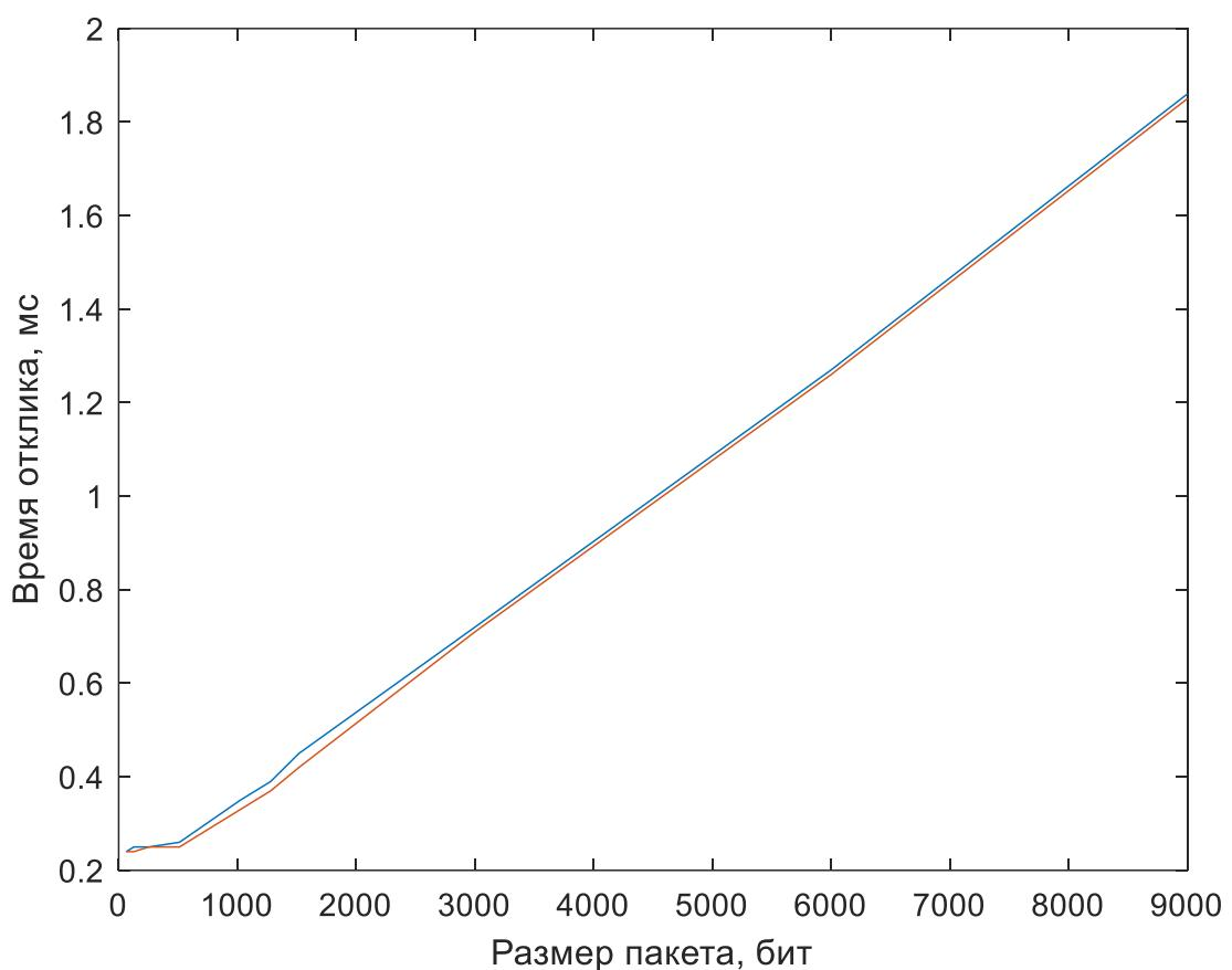
Рисунок 36. Зависимость времени отклика от размера пакета при использовании протокола IPv4 (синий) и IPv6 (оранжевый)
