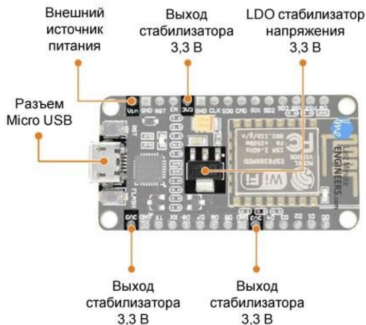
Рисунок 2. Элементы питания ESP8266 NodeMCU
